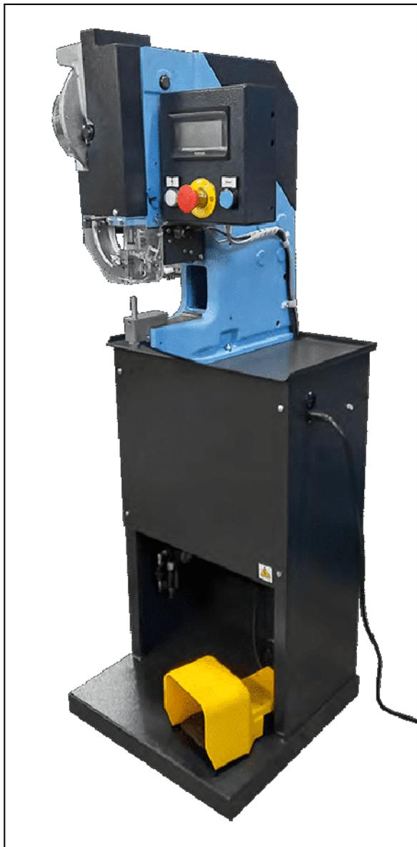
Macchina rivettatrice automatica a motore elettrico (disponibile anche in versione pneumatica Mod. M11R-P ) per l'applicazione di rivetti con diametro della testa fra 3 e 20mm. Il caricatore facilmente intercambiabile permette l'applicazione di ogni tipo di rivetto. Può essere usata come macchina semiautomatica per rivetti o bottoni jeans come pure bottoni a pressione o rivetti maschio femmina.
