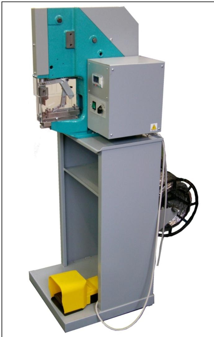
Macchina automatica a motore elettrico, monofase, viene utilizzata per l'applicazione di capocorda a nastro su elastici o cordoni.
