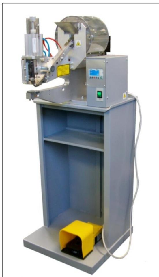
Macchina automatica elettropneumatica per applicazione di borchiette ornamentali a quattro punte con caricatore intercambiabile per misure comprese fra formato 7 e 40 (2,3÷9,0mm).
